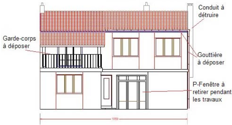
Vue Façade Ouest, avant Travaux
